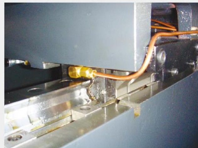
所有注油潤滑系統均使用銅管材質
