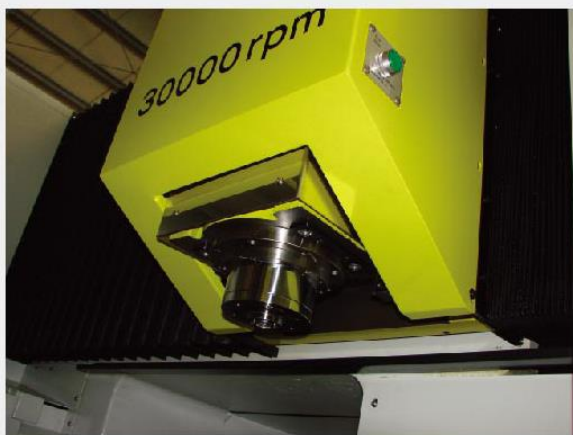
突然斷電時，Z軸會自動上昇，不會損傷工件
