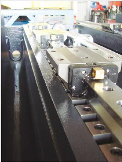
滾柱型線性滑軌及荷重型滑塊
