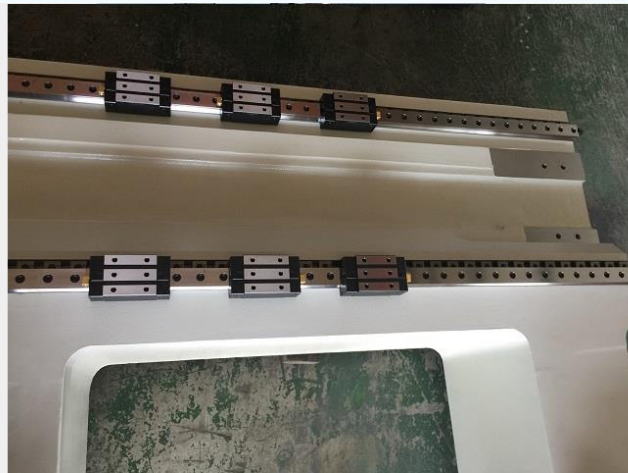
Y軸採用線軌六滑塊設計
