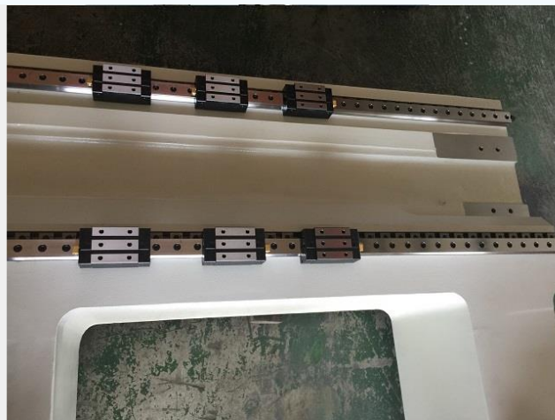
Y軸採用線軌六滑塊設計
